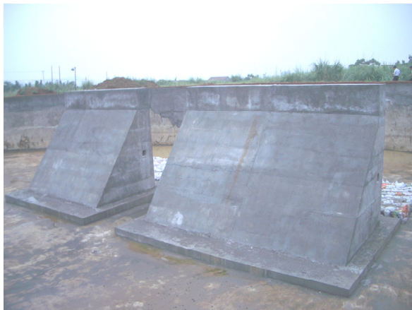
Fig. 3.3 Actual 1/10 Cofferdam Model
